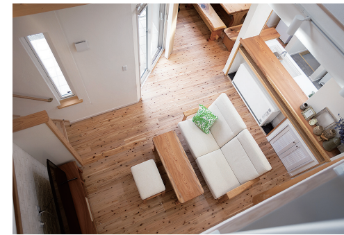
キッチンカウンター下に設置された蓄熱暖房機から吹き抜けを通じて暖気が上昇。夏は2階の階段ホールから冷気が降りていく
